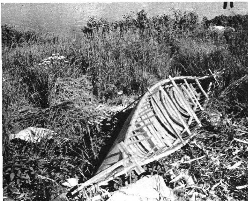
PLANCHE XVII Séchage des varangues dans leur moule
